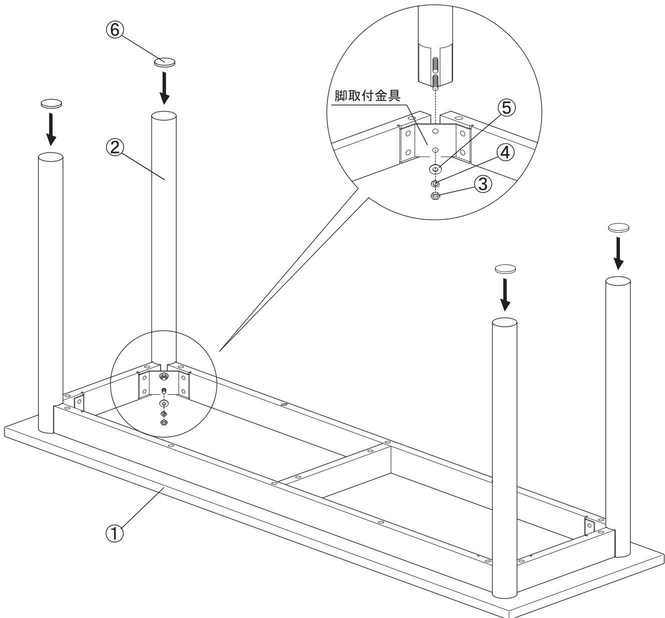
製品にガタツキが生じる場合は、③ナットを一度緩め、製品を起こした状態でガタツキがないか確認し、そのまま③ナットを締め直してください。
